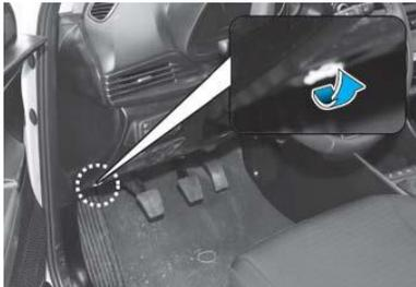
Tire de la palanca de apertura para desbloquear el capó.
