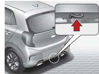
El gancho de remolque está situado en el portaherramientas en la puerta trasera
